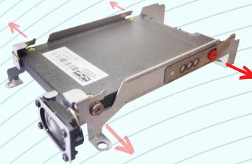
2.6- FIXE A NOVA UNIDADE DE ARMAZENAMENTO NA GAVETA OBSERVANDO A POSIÇÃO CORRETA DOS CONECTORES, EM RELAÇÃO A POSIÇÃO DE FIXAÇÃO DA GAVETA NO GABINETE E COLOQUE OS QUATRO PARAFUSOS UTILIZANDO UMA CHAVE TIPO "PHILIPS 6".
