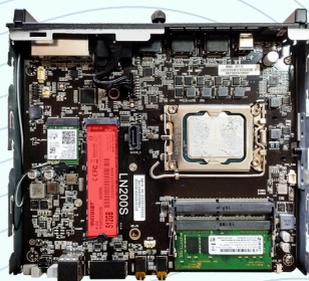
3.3- APÓS RETIRAR O PINO DE FIXAÇÃO DESTACADO EM VERMELHO NA ILUSTRAÇÃO ABAIXO, BASTA PUXAR O MÓDULO SSD NO SENTIDO OPOSTO;
