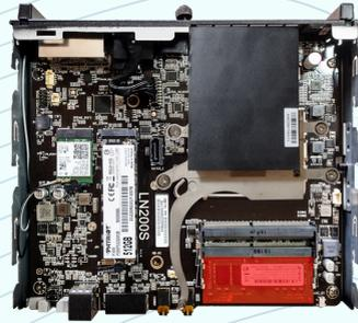
A- PARA RETIRAR O MÓDULO DE MEMÓRIA PREENSIONE SUAVEMENTE AS TRAVAS LATERAIS DO SLOT (ENCAIXE DA MEMÓRIA) DE DENTRO PARA FORA, OBSERVANDO O SENTIDO CORRETO NA IMAGEM AO LADO.
